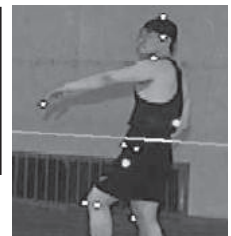
隠れたマーカ位置を推測しやすい「デジタイズ補助線」
