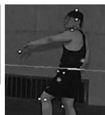
隠れたマーカ位置を推測しやすい「デジタイズ補助線」
