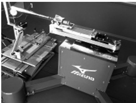
図1. バットスイングロボット
